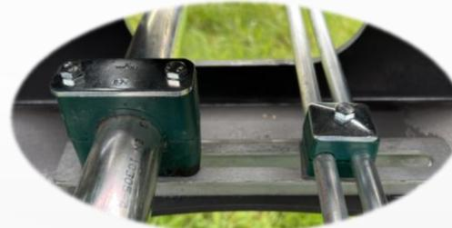
**Leitungsträger** zur sicheren Führung der **Hydraulikleitungen** im Hilfsrahmen
