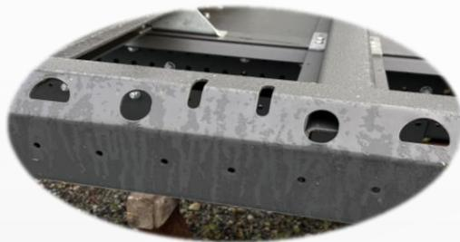
45° Außenrahmen mit diversen **Verzurr Möglichkeiten** (Außenrahmen bis **2500 daN** geprüft)
